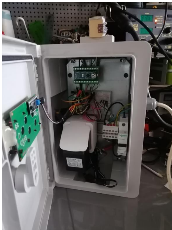
Слика бр:11. Унутрашњи изглед уређаја за комуникацију са котловским рачунаром, мерење и чување података
