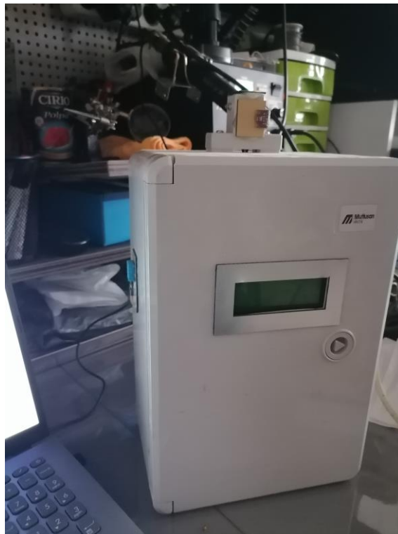
Слика бр:10. Спољни изглед уређаја за комуникацију са котловским рачунаром, мерење и чување података
